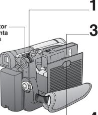
Ajuste el interruptor de alimentación (POWER) a la posición VCR o CAMERA.
